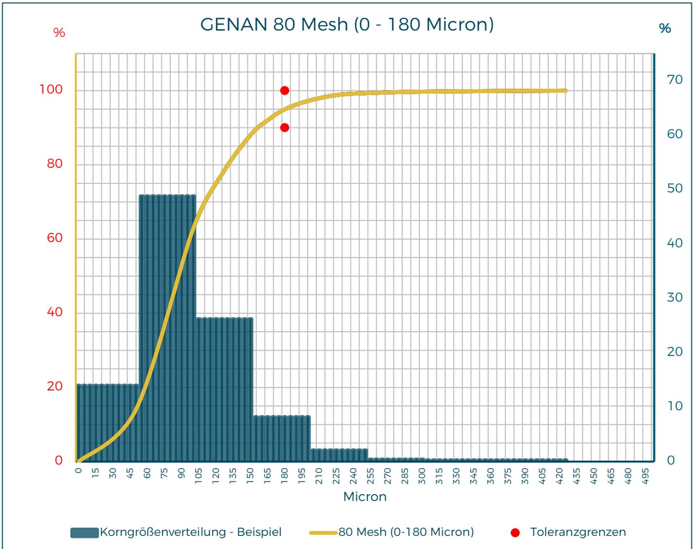
Die Siebanalyse des Materials wird mit einem Luftstrahlsieb 200 LS der Firma Hosokawa Alpine durchgeführt / Testsiebe nach DIN ISO 3310-1.
